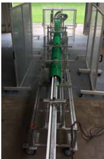
Darstellung eines Prüfaufbaus nach ÖNORM B 5141 im neuen iro Prüfstand
