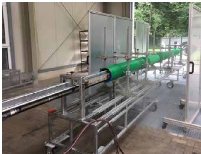
Darstellung eines Prüfaufbaus nach ÖNORM B 5141 im neuen iro Prüfstand
