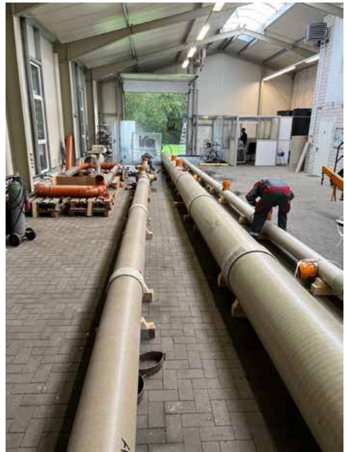
Abbildung 2: Praxisprüfungen nach DIN 19523 in der Forschungshalle der iro GmbH Oldenburg (Amiblu)
