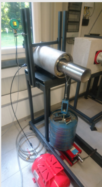
Bild 9: Beispiel Wasserdichtheitsprüfung unter Scherlast einer Ringraumdichtung DN 200
