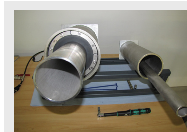
Bild 8: Beispiel Prüfung der Gasdichtheit einer Ringraumdichtung DN 200
