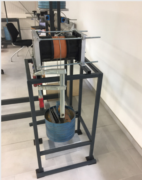
Bild 12: Beispiel Dichtungsprüfung unter radialer Last bei Kabeldurchführungen
