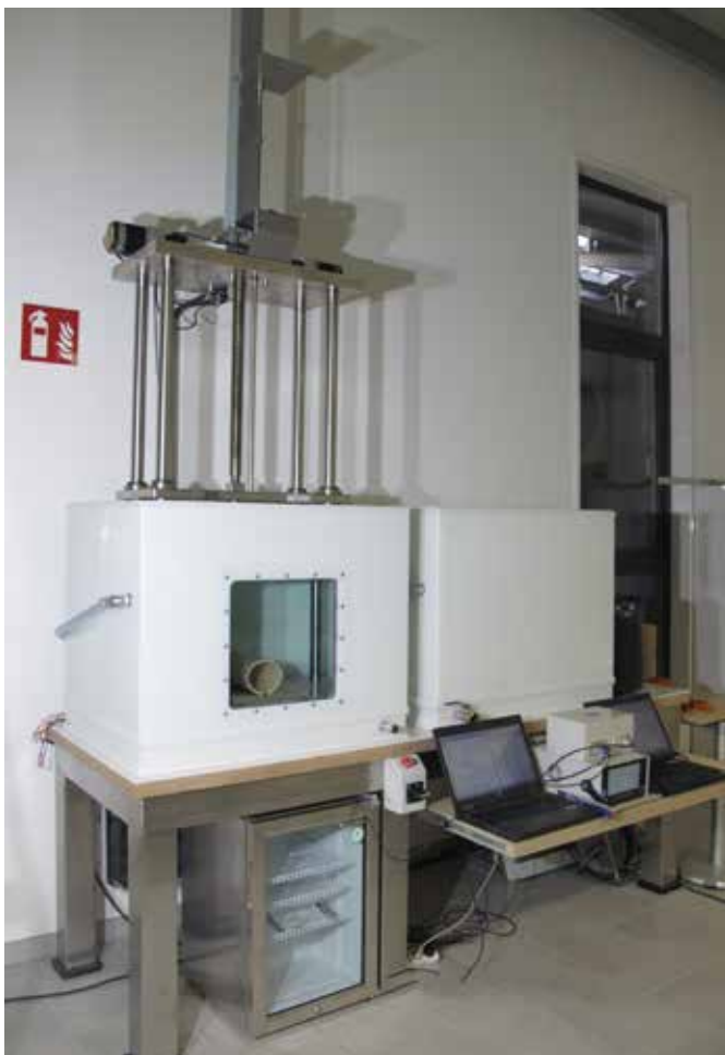
Selbstentwickelte Prüfeinrichtung zur Integritätsprüfung von PVC-U Rohren
