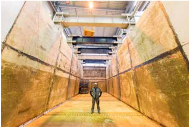
Für 1:1-Versuche: IKTs Großversuchsstand misst 18x6x6 Meter.
