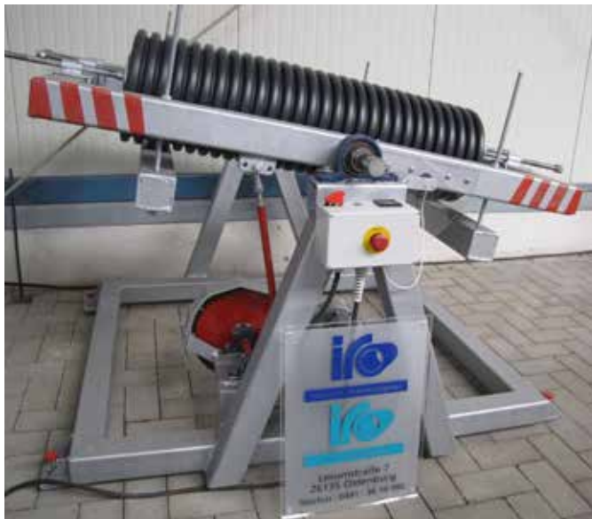
Prüfeinrichtung zum Abriebversuch nach DIN EN 295-3 und DIN EN 598
