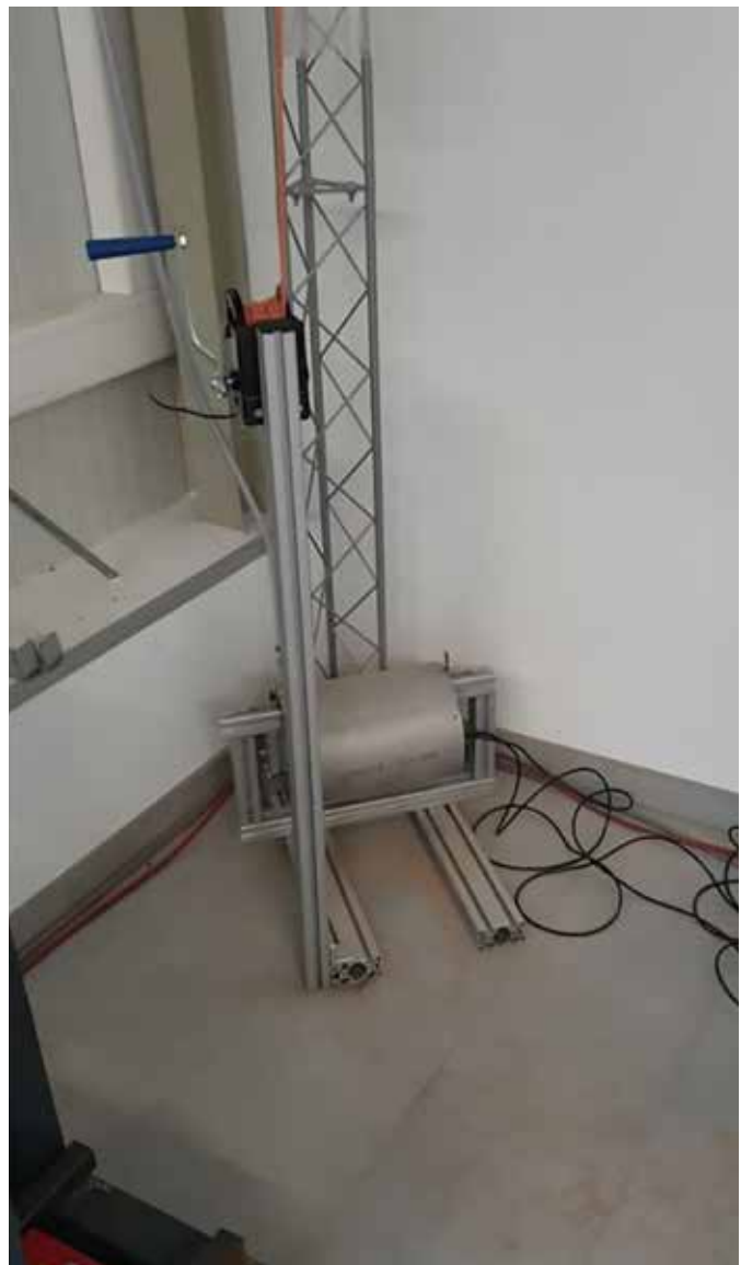
Schlagversuche zur Verifizierung des Fallgewichts
