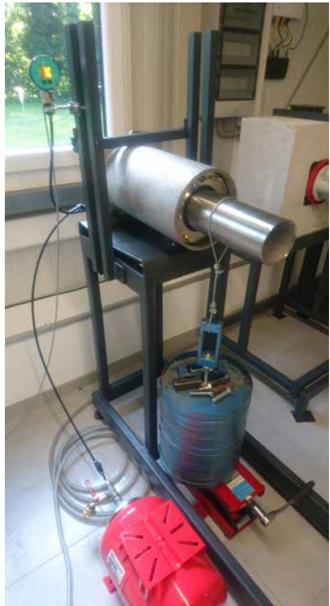
Abbildung 2: Beispiel Wasserdichtheitsprüfung unter Scherlast einer Ringraumdichtung DN 200
