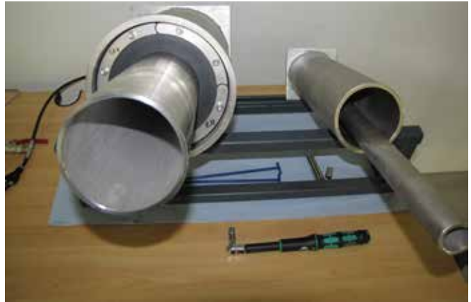
Abbildung 1: Beispiel Prüfung der Gasdichtheit einer Ringraumdichtung DN 200
