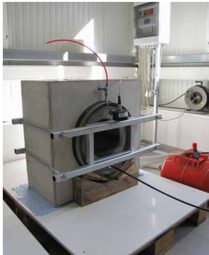
Abbildung 4: Beispiel einer Längswasserdichtigkeitsprüfung eines Futterrohrs
