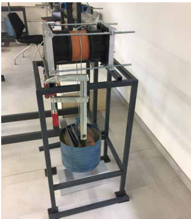
Abbildung 5: Beispiel Dichtheitsprüfung unter radialer Last bei Kabeldurchführungen
