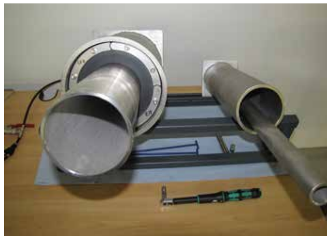
Beispiel Prüfung der Gasdichtheit einer Ringraumdichtung DN200
