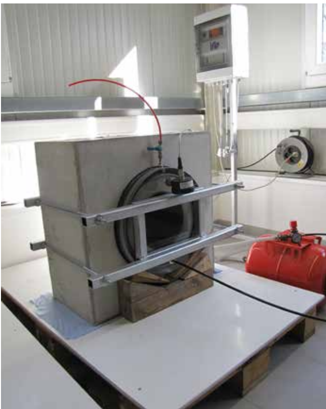
Beispiel einer Längswasserdichtigkeitsprüfung eines Futterrohrs
