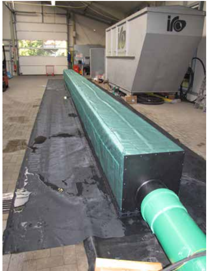
Abb. 2: ENREGIS/Controlbox®-Prüfstrecke in der iro-Forschungshalle
