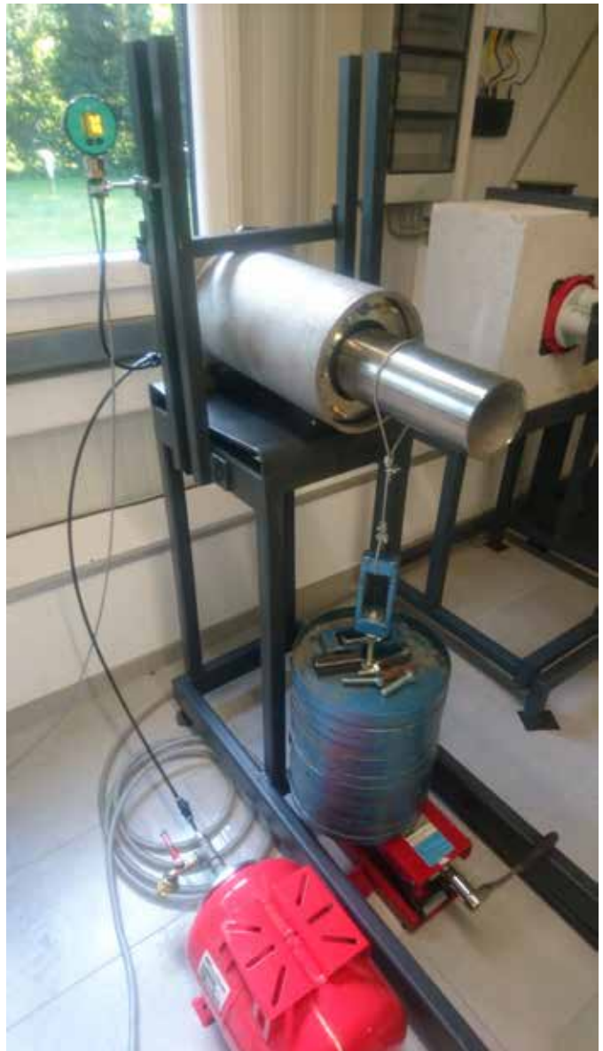
Beispiel Wasserdichtheitsprüfung unter Schwerlast einer Ringraumichtung DN 200
