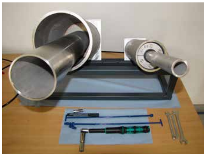
Bild 1: Prüfung einer Ringraumdichtung DN 100 nach GE 101: Gasdichtheit
