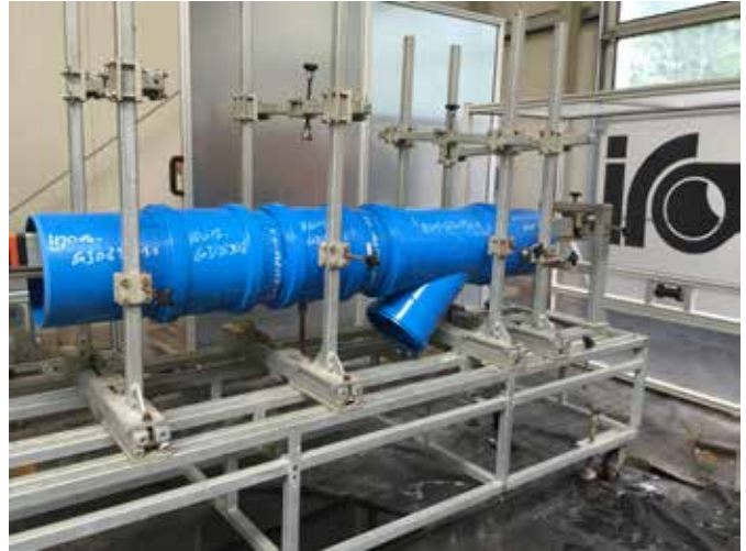
Prüfmuster im Prüfstand zur Prüfung nach DBS 918 064 (Fabrikat Funke Kunststoffe)
