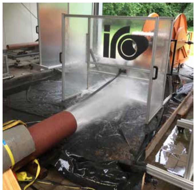
Prüfungsdurchführung der Praxisprüfung nach DIN 19523 (Fabrikat Funke Kunststoffe)
