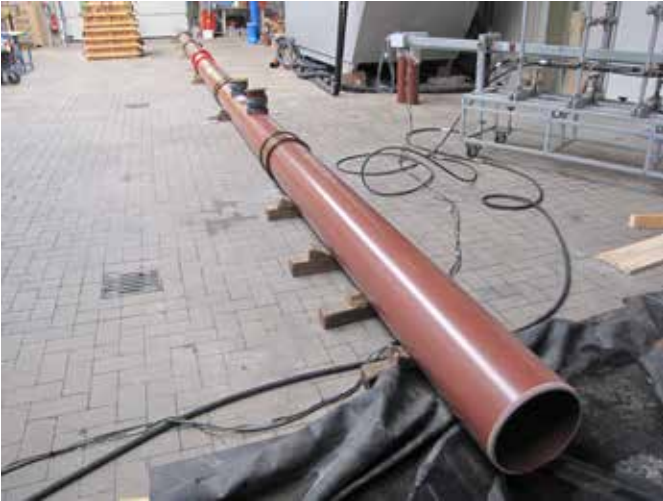
Prüfaufbau der Praxisprüfung nach DIN 19523 (Fabrikat Funke Kunststoffe)
