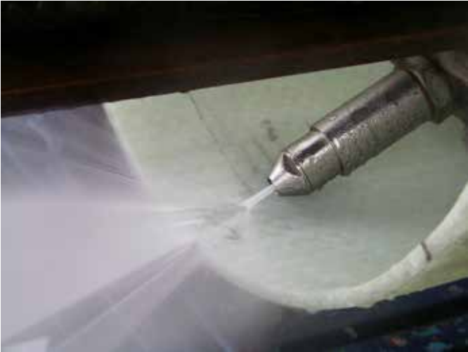
Werkstoffprüfung nach DIN 19523 / Verfahren 1
