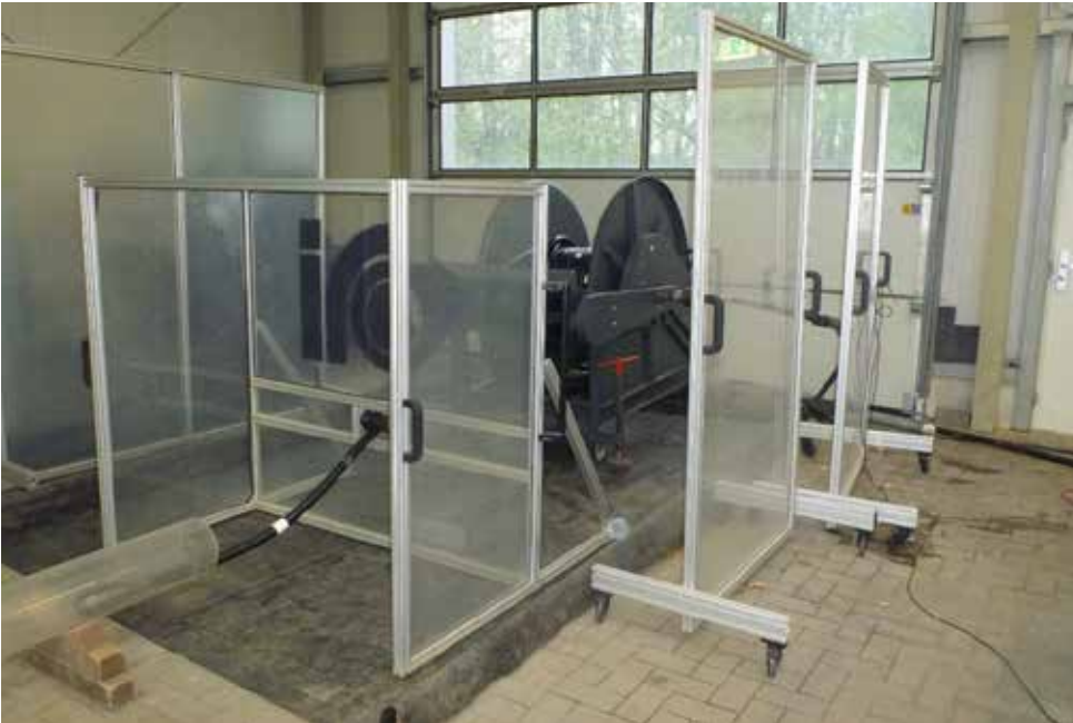
Schlauchhaspel im Einsatz bei Verfahren 2 (Praxisprüfung)
