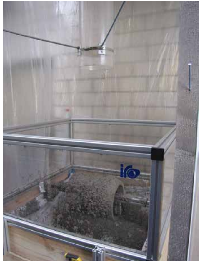
Mit Betonschüttung belastetes Prüfmuster
