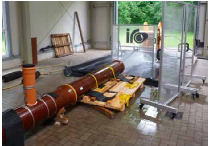
Abb. 4: Praxisprüfung gemäß DIN 19523
