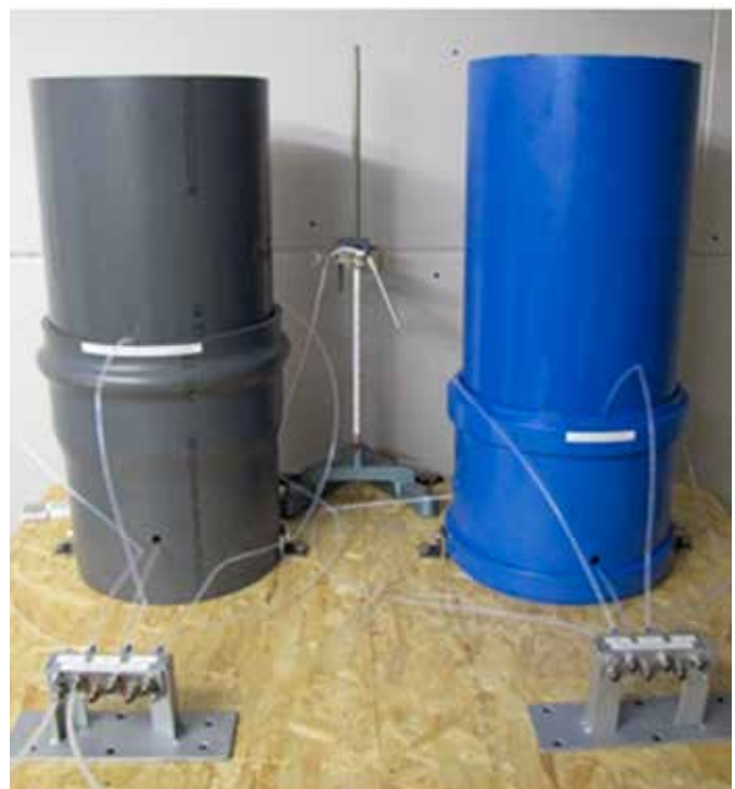
Abb. 7: Versuchsanordnung Langzeitdichtverhalten von Rohrverbindungen
