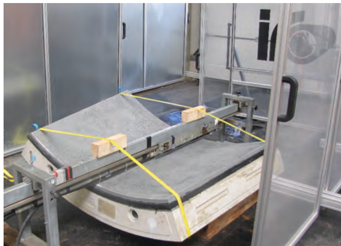
Abbildung 2: Tübbing mit Polymerbetonoberfläche im iro-Veruchsstand
