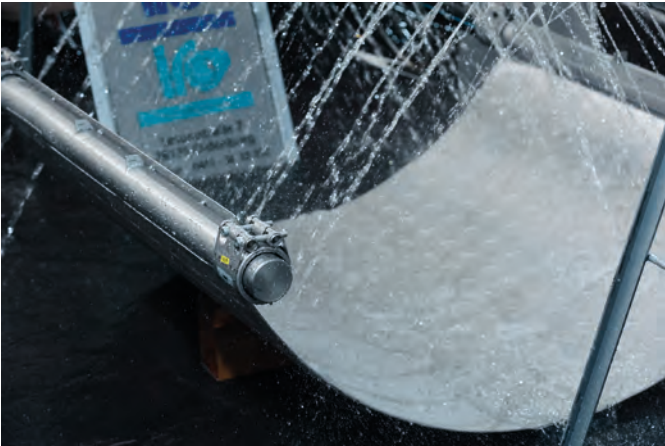
Abwasserwärmeübertrager im Oldenburger Effizienztest
