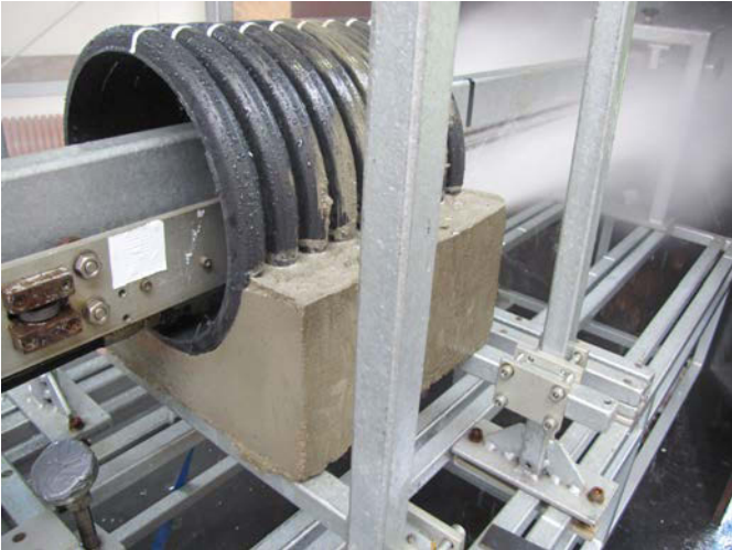
Bild 2: Prüfung der Rohrwiderstandsfähigkeit gegenüber HD-Spülstrahlen (iro)
