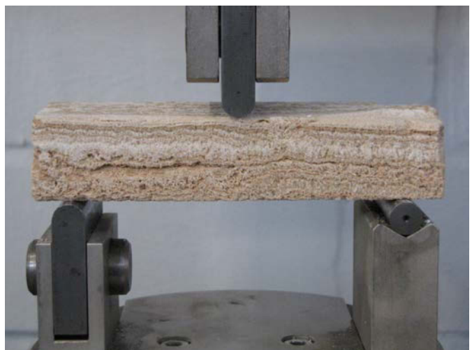
Bild 4: Dreipunktbiegezugversuch an einer Sinterprobe (iro)
