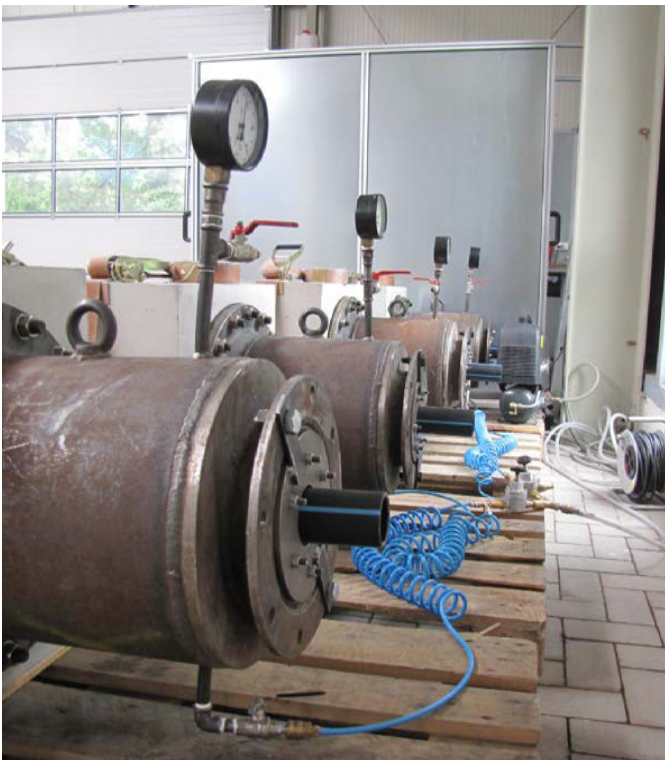
Bild 1: Prüfungsaufbau der Langzeit-Druckprüfungen in der Forschungshalle der iro GmbH Oldenburg
