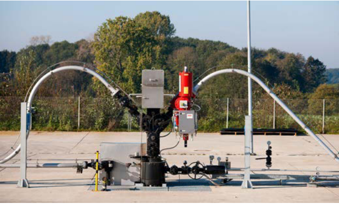
E-Kreuz (Eruptionskreuz) des Bohrlochabschlusses einer Erdgasbohrung während der Förderung
