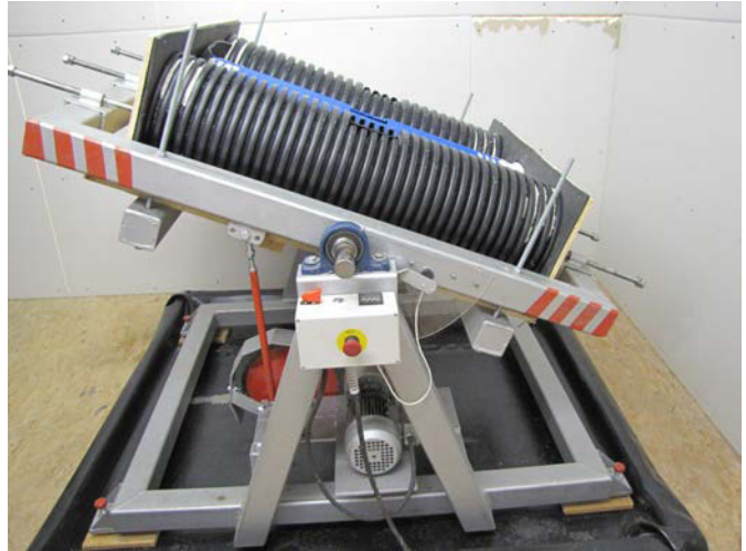
Bild 3: Prüfung der Abriebfestigkeit im Prüfstand der iro GmbH Oldenburg (iro)
