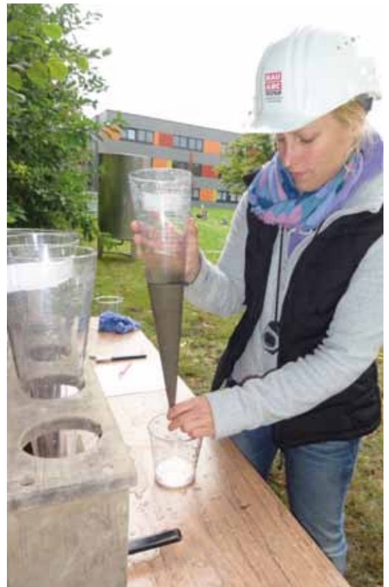
Ermittlung des Restsandgehaltes mit Hilfe des Imhofftrichters.
