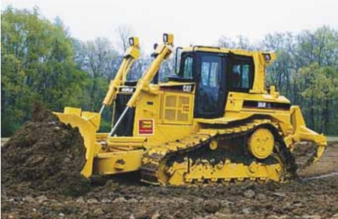
*Tiefenlockerung der Trasse durch Planierdrape mit Heckaufreißer
