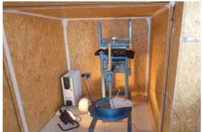
Wärmeschrank mit eingestelltem Versuchsstand
