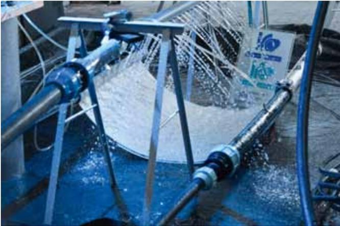
Abbildung 6: Wärmetauscher während der Prüfung
