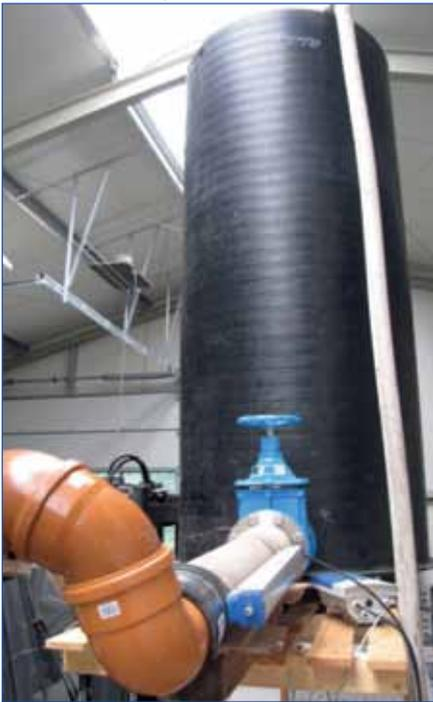
Abbildung 2: Durchflussmessung im Ausgang des Hochbehälters
