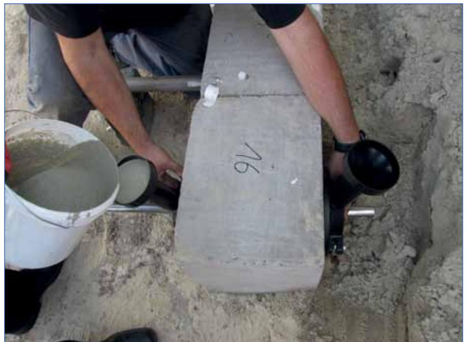
Verwendung von Einfüllstutzen beim Einbringen eines Quellvergussmörtels in den Probekörperingraum
