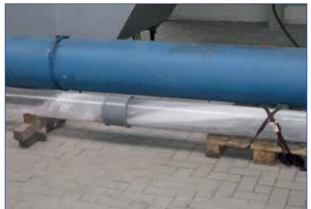
Simulation der Kanalreinigung mittels Hochdruckwasserstrahlen
