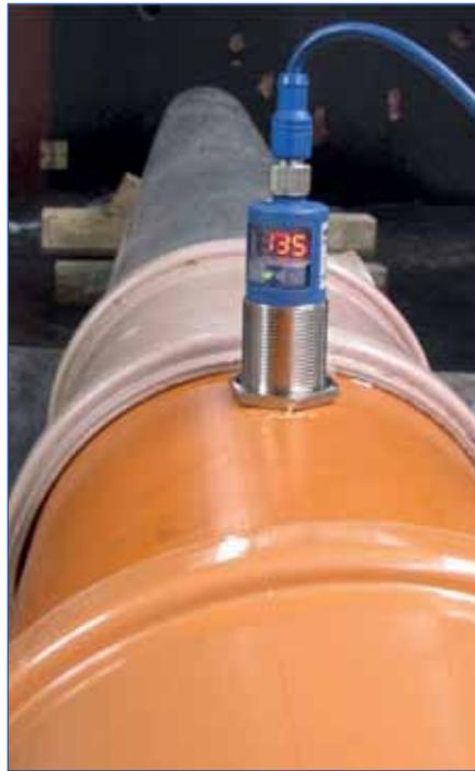
Abbildung 3: Füllstandsmessung in den Anschlussleitungen
