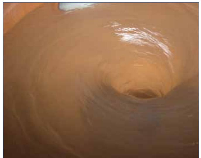
Abbildung 3: Einlaufverhalten bei 180°-Anschluss mit Mittelschachtsegment
