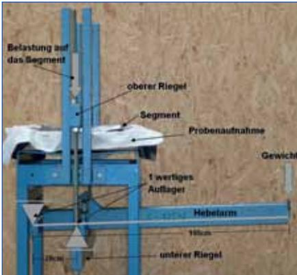
Abbildung 1: modifizierter Scheiteldruckversuchsstand
