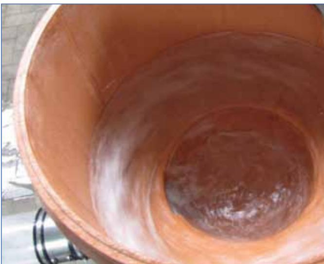
Abbildung 2: Einlaufverhalten bei 90°-Anschluss ohne Mittelschachtsegment
