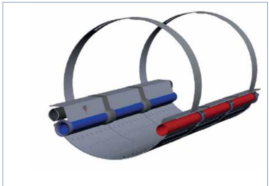
Abbildung 1: 3D Zeichnung des Wärmetauschersystems „THERM-LINER“ der Firma Uhrig Kanaltechnik GmbH
