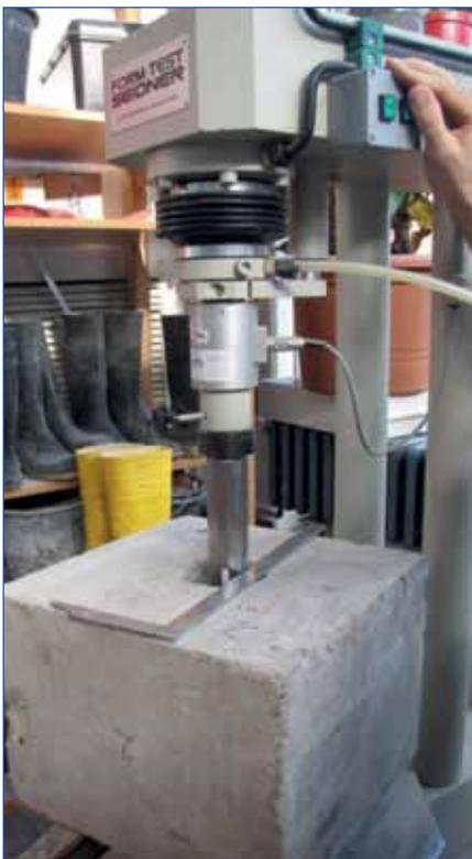
Hydraulische Druckprüfmaschine während der Prüfung an einem Probekörper
