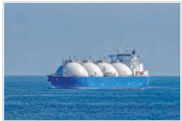
Erdgas wird an der Quelle mit Gasverflüssigungsanlagen zu LNG verflüssigt und mit Tankschiffen transportiert. (Foto: iStock / IgorSPb)
