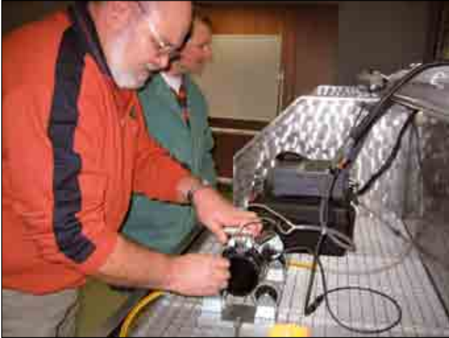
Untersuchungen zum TOFD-Verfahren zur zerstörungsfreien Prüfung von PE-Schweißverbindungen auf Baustellen (mit eon-Ruhr-gas, jetzt Open Grid Europe)
