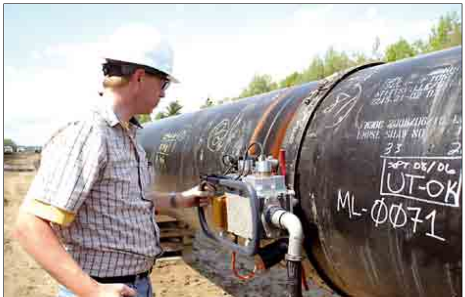
Ultraschall-Prüfung von Verbindungsnahten
