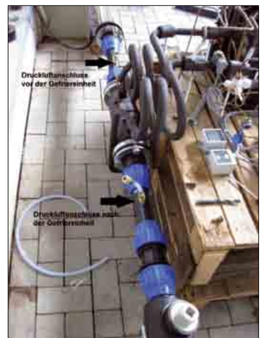
Mit Druckluftanschlüssen optimierte Prototypanlage
