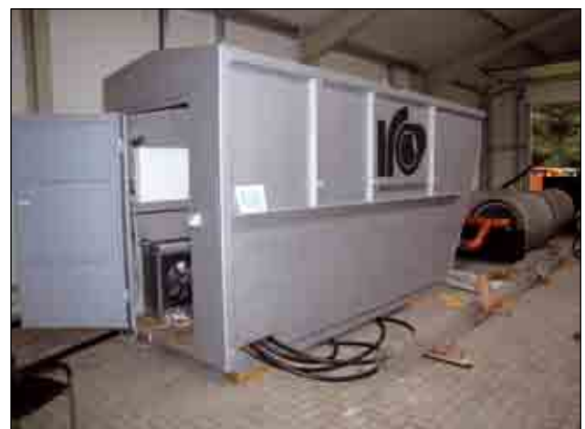
Abbildung 2: Mobile Messeinheit zur Ermittlung der Wärmeleistung
