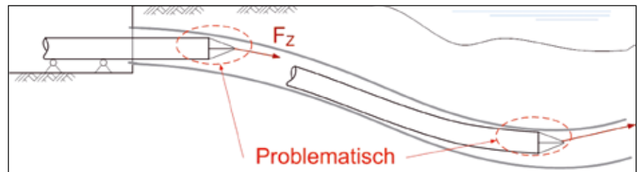
Abb. 2 Skizzierte Darstellung über die Problematik im Tunnelinneren
