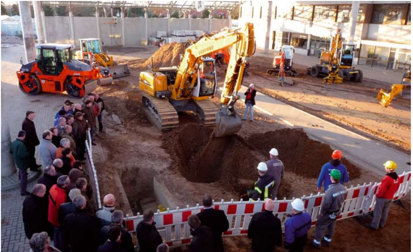
Abb. 2 Simulation einer abreißenden Gasanschlussleitung
