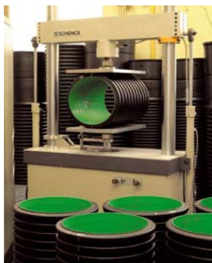
Prüfung der Eigenschaften von Rohren bei dynamischer Beanspruchung
