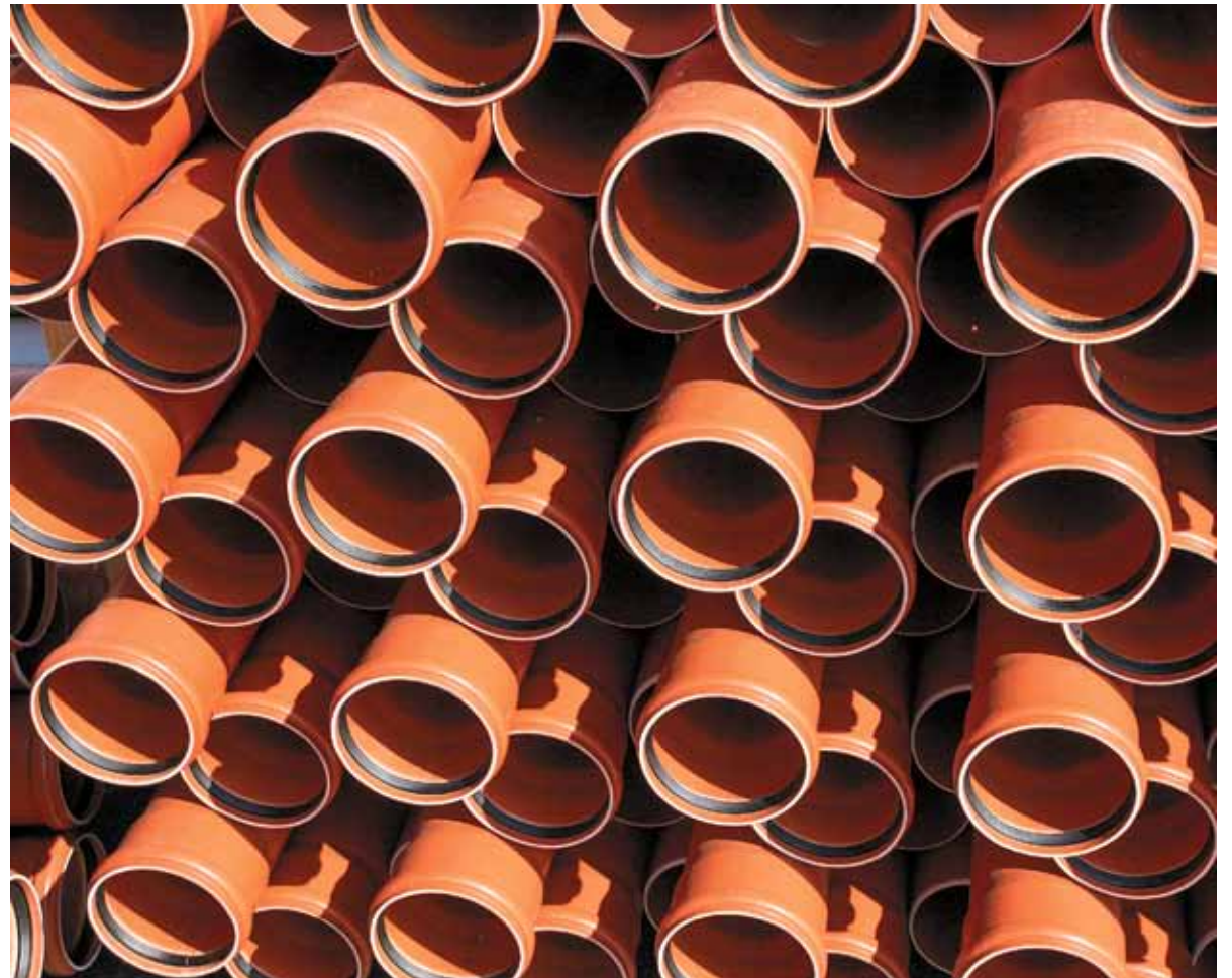
Langlebig: Kunststoffrohre liegen oft mehr als 100 Jahre in der Erde. Laut Verband lässt sich das Material danach wieder verarbeiten. Foto: Pixabay/admarkt
