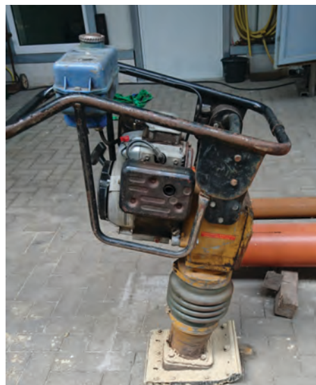
Bildserie 6: Eingesetzte Verdichtungsgeräte (links: Belle LC3228, 64 kg, rechts: Weber SRV 70, 71 kg)
