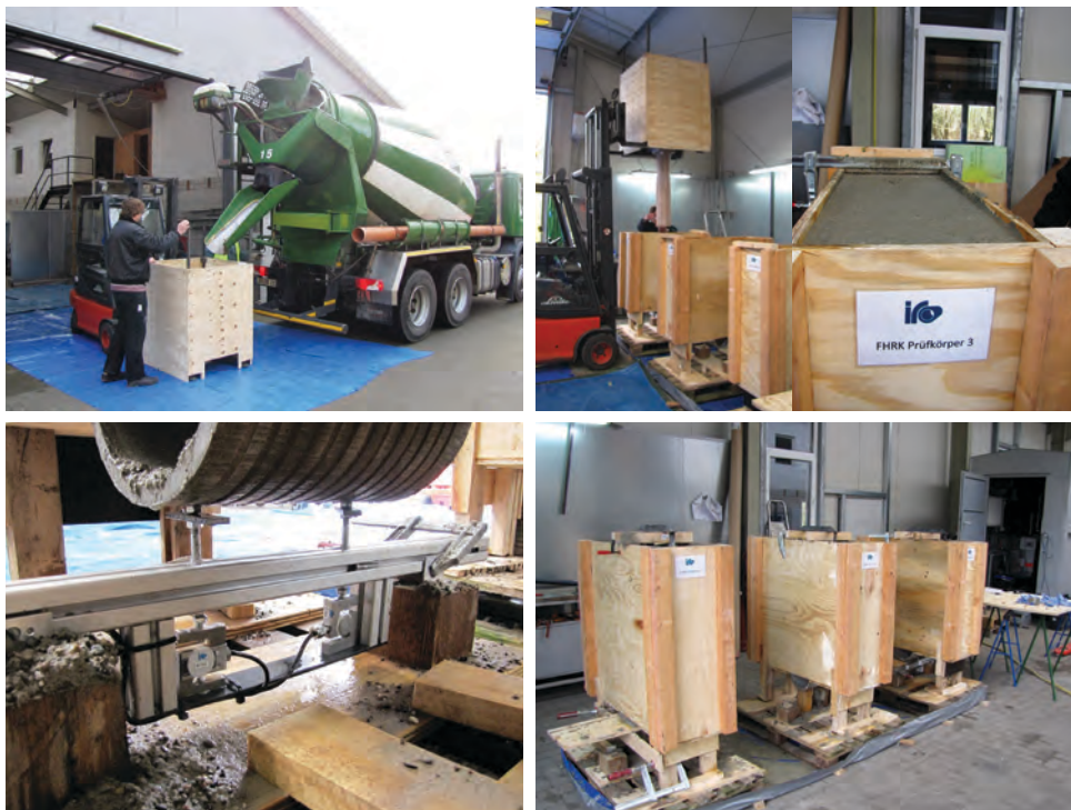
Bildserie 4: Betonierversuche (Versuchsaufbau 3) in der Forschungshalle der iro GmbH Oldenburg
