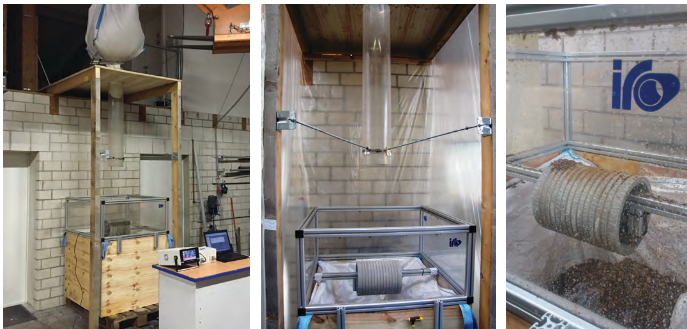
Bildserie 1: Versuchsaufbau Schlagkraftermittlung im Schüttversuch
