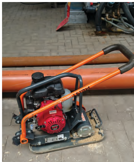
Bildserie 6: Eingesetzte Verdichtungsgeräte (links: Belle LC3228, 64 kg, rechts: Weber SRV 70, 71 kg)
