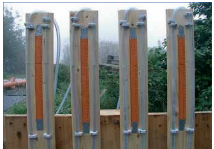
Abb: Messstellen nach dem Schlauchwaagenprinzip
