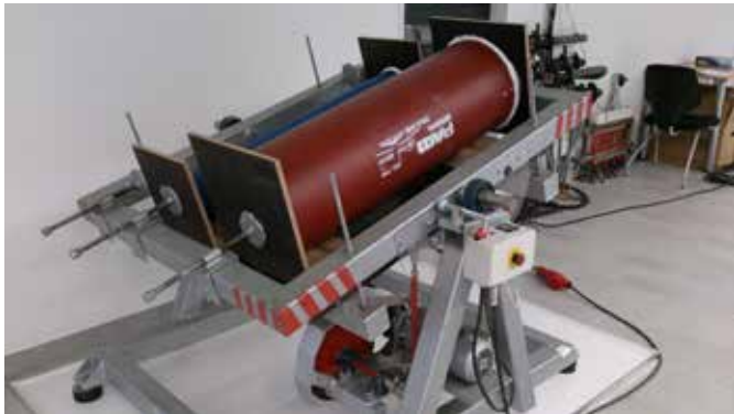
Prüfmuster im Prüfstand zur Prüfung der Abriebfestigkeit nach DIN EN 598
